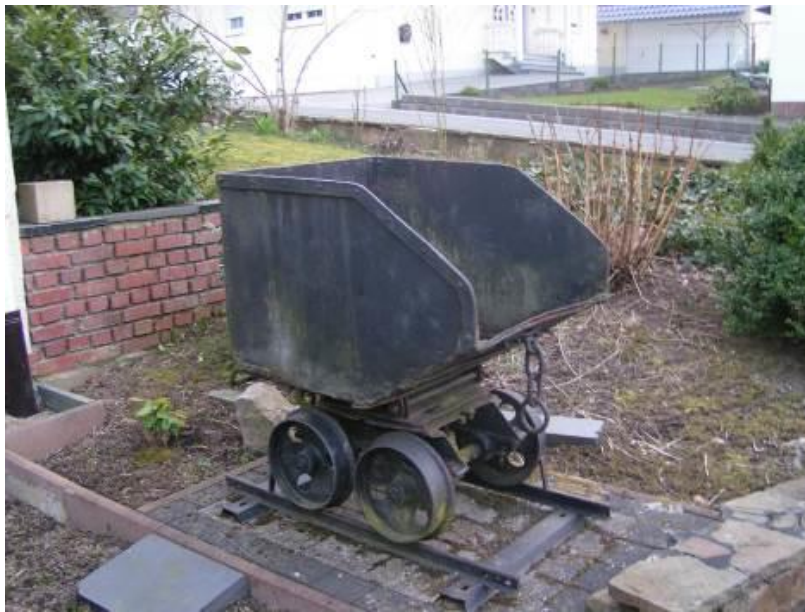
Schnabelkipper wie er auf Saturn unter Tage verwendet wurde
